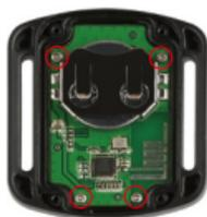
3. 図のように、PCB ボードを持ち上げてバッテリーを引き出します。
